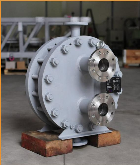
Die Betriebsbedingungen Ihres Wärmeübertragungsprozesses bestimmen die Plattendicke sowie das verwendete Platten- und Mantelmaterial. Als Standard-Plattenmaterial verwenden wir 1.4404 (AISI 316L) mit einer Dicke zwischen 0,6 und 1,5 mm. Bei hohen Temperaturen, aggressiven Medien oder Seewasser nutzen wir Nickelbasis-Legierungen oder Titan.
